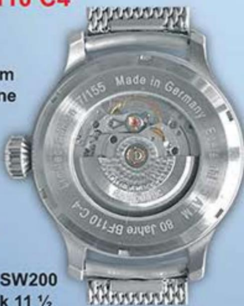
Glasboden mit Sicht auf das ARISTOMATIC SW200 Automatic-Werk 11 1/2 mit dekoriertem Rotor, 26 Steine, 28.800 A/h, Incabloc-Stoßsicherung,
