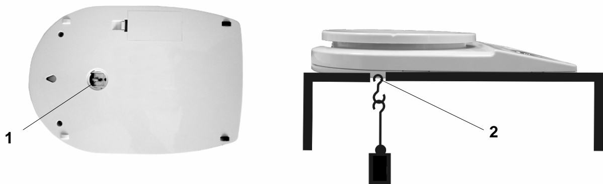
Abb. 1: Einrichten der Waage für Unterflurwägungen
